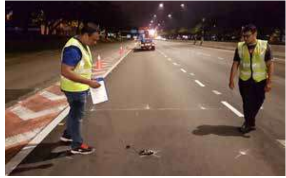
Gambar 3.20 : Kerja Penggantian Lampu Jalan LED di Jalan Tebrau, Jalan Skudai dan Jalan Tun Abdul Razak serta Ujian Pencahayaann (Lux Measurement) bagi memastikan cahaya mengikut spesifikasi ditetapkan.
